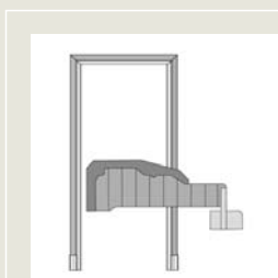
Das zur Zarge passende Sockelstück ist bereits im Zargenprofil integriert
