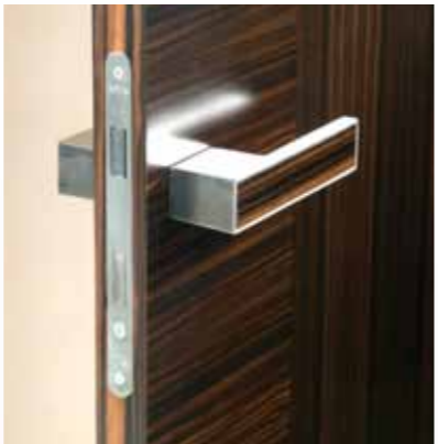
Magnetfalle: der neue Standard bei flächenbündigen Türen. Die Falle ist ebenfalls flächenbündig eingebaut und schliesst erst, nachdem die Türe bereits geschlossen ist. Spezialmagnete lösen diesen Mechanismus aus.
